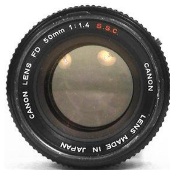
Objectif photographique. FD – l'indicateur du modèle de l'objectif 50mm – distance focale 1.4 – l'ouverture maximale du diaphragme
