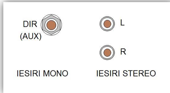
Fig. 4. Porturile de ieșire ale mixerului audio.
